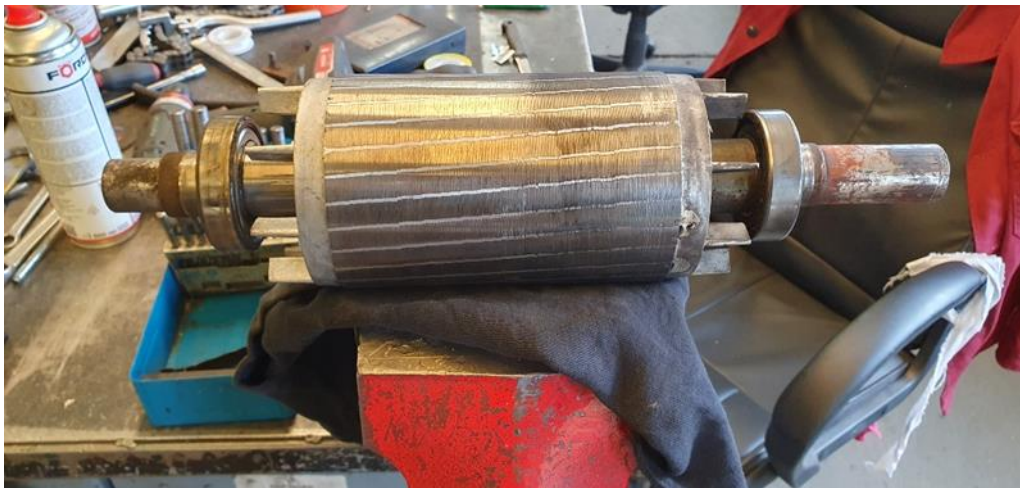
18. ábra. Villanymotor forgó egysége kiszerelt állapotban a tengely két végén golyóscsapágyakkal
