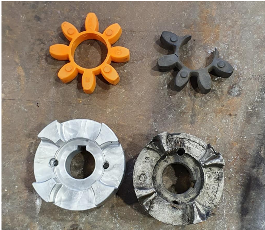
17. ábra. A tengelykapcsoló alumínium fele és csillagbetétjének meghibásodás utáni állapotának összehasonlítása egy új alkatrészsel
