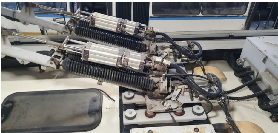
20. ábra. GST 12D-2 tetején megtalálható pneumatikus áramszedő berendezés
