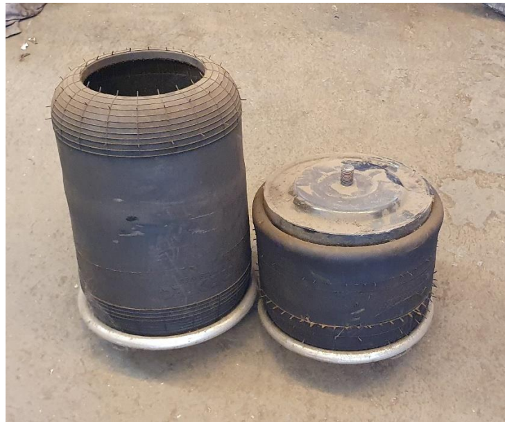
13. ábra. A GST 12 trolibuszban használt lérugók kiserelt állapotban
