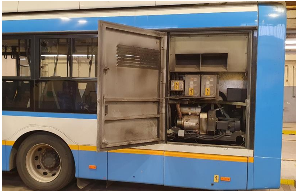
12. ábra. BRQ4/10/35 TFH típusú fékkompresszor elhelyezkedése GST 12D és a GST 12D-2 típusú járműben
