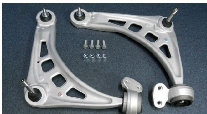
17. ábra: BMW E46 erősített első lengőkarok, Meyle HD típusú utángyártott alkatrész [26]
