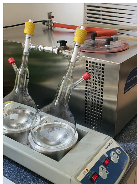
2. ábra NPDO ^{14}\text{C} minta-előkészítés vákuumbepárlási folyamatának szemléltetése
