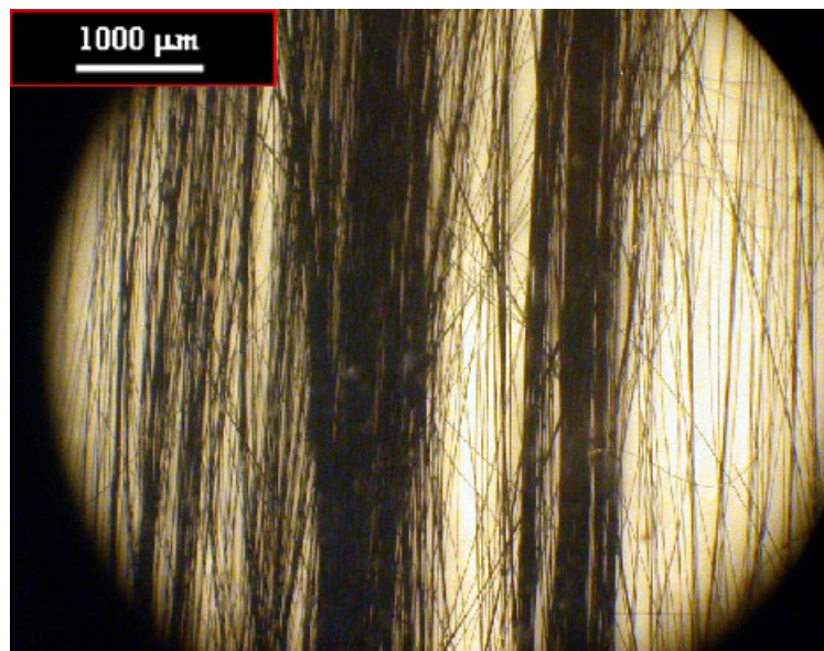
19. ábra: Szénszállal erősített lágy PVC kompozit fénymikroszkópos képe
