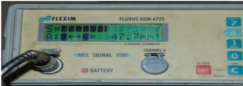
15. ábra: A tesztmérésekhez alkalmazott mobil ultrahangos áramlásmérő kezelőfelülete
