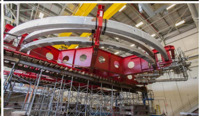
7. ábra. A müöngyűrű szállítása a New York melletti Brookhaven Nemzet Laboratóriumból a Chicago közelében levő Fermilabba vízen és közúton. Az utakon éjjel közlekedtek, és gyakran kellett leszerelni lámpaoszlopokat és útjelző táblákat.
