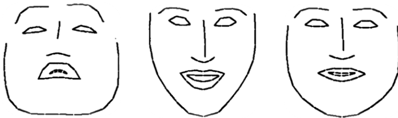
17. ábra. A b paramétervektor változtatásával generált alakzatok. Az egyes b_i \in \mathbb{R} komponensek \pm 3\sqrt{\lambda_i} intervallum felett voltak értelmezve.
