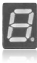
23. ábra, Egy hét szegmenses kijelző kikapcsolt állapotban. (forrás [x.]
