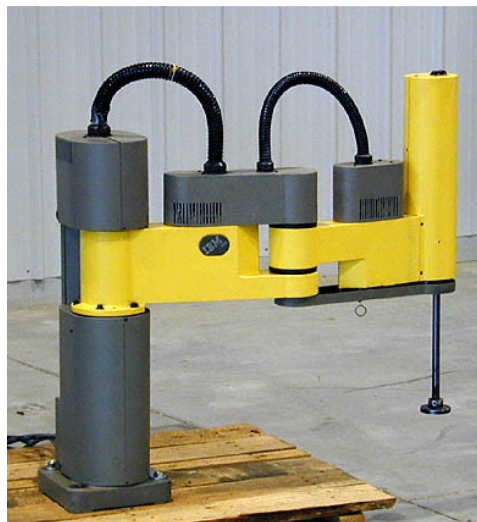
5. ábra, Egy IBM 7576 Scara robotkar, ami - az egyetemen is oktatott - AML nyelven programozható (forrás [14.]
