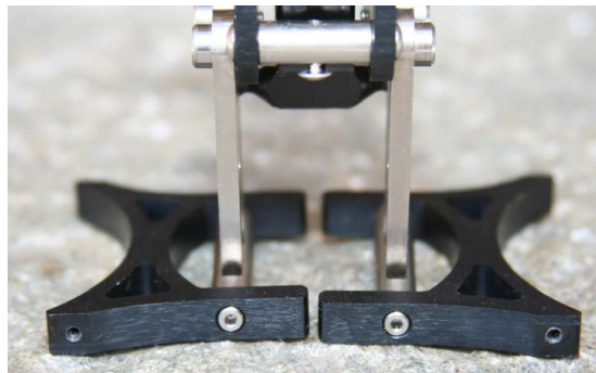
17. ábra, A Penguin robot lábai tengellyel kapcsolódnak a talpakhoz (forrás [21.]
