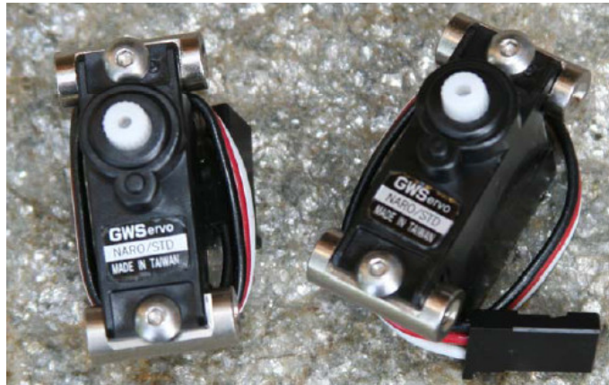
9. ábra, A Penguin robot mikro szervo motorjai (forrás [21.])
