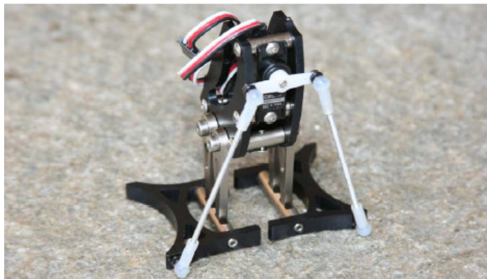
8. ábra, A Penguin robot mechanikai rendszere: a szervo motorok és vázszerkezet összeszerelve (forrás [21.]
