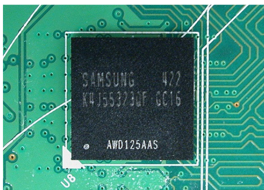
22. ábra, Példa egy RAM memóriachipre (forrás [25].)
