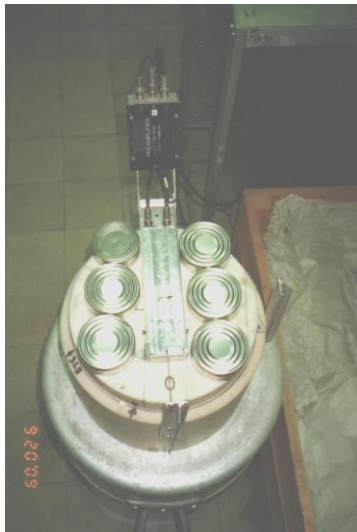
3.1.2. ábra: Az ETNA mérési összeállításban a detektor, ill. a mintatartó doboz mintákkal
