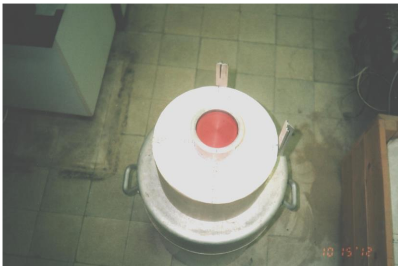
3.2.3. ábra: Az aktivációs mérésnél használt moderátor mintatartó edénnyel és reflektor anyaggal
