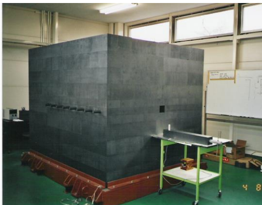
2.4.4. ábra: Mérési elrendezés grafitmáglyába helyezett minta analizésére [49]
