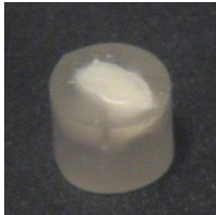
1. ábra. A csiszolással szabaddá tett zománcfelület a beágyazást követően
