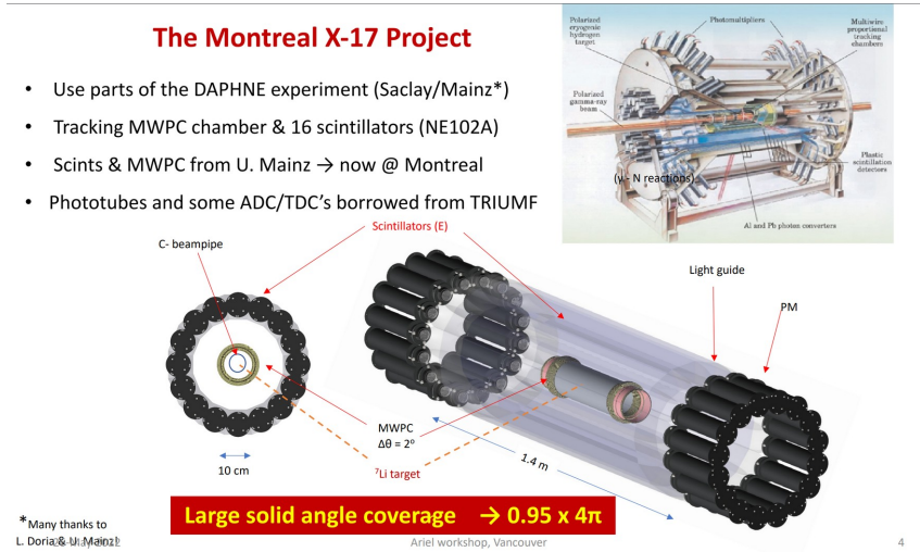
3.8. ábra. A montreáli kísérlet detektorrendszerének felépítése. Az ábrán a sokszálas proporcionális számláló (MWPC) látható, amelyet körkörös elhelyezett szcintillátorrudak vesznek körül.
