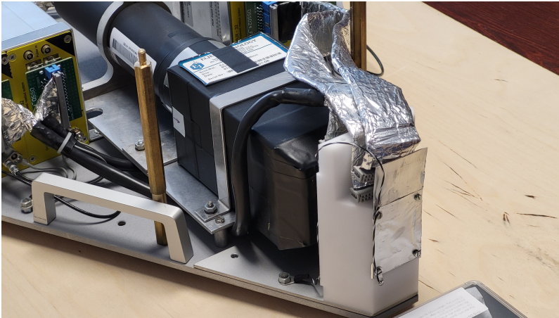
4.6. ábra. Az egyik teleszkóp fényképe a főbb szerkezeti elemek feltüntetésével. A képen látható a kis DSSD detektor, a hozzá tartozó vezetékek alumínium árnyékolása, mögötte a plastik detektor, valamint oldalt a MUX-32 kiolvasóegységek.
