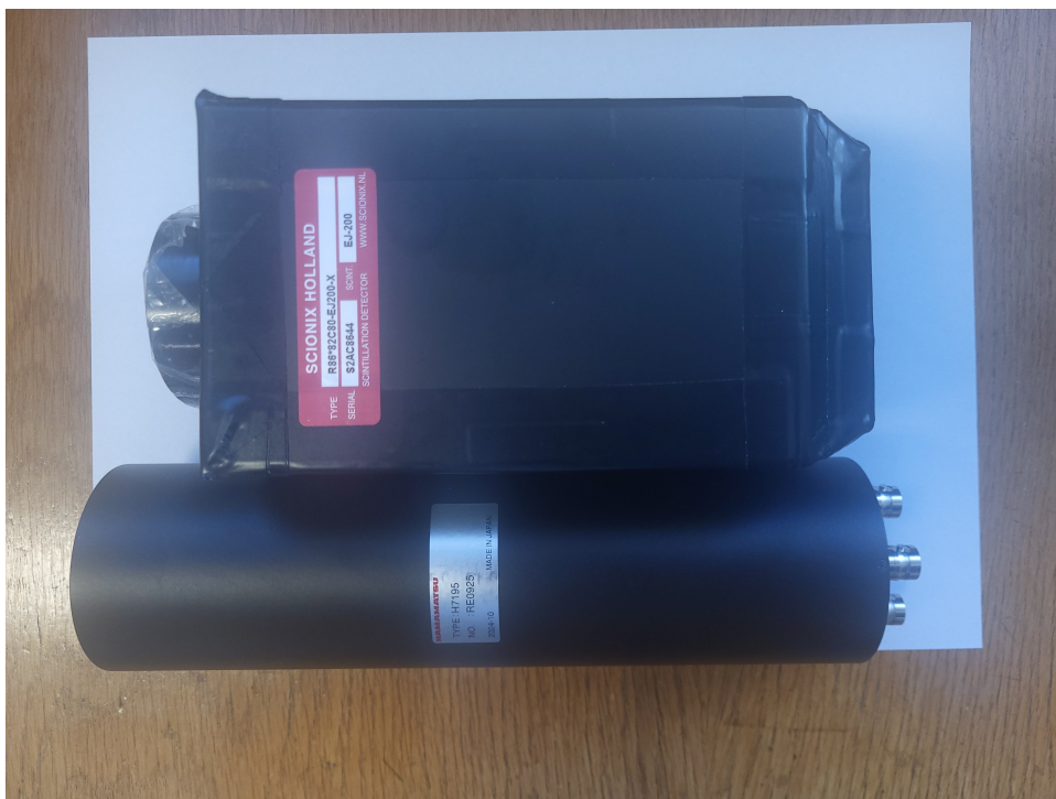
4.8. ábra. Az EJ-200 típusú szcintillátor detektor és a mellette elhelyezett fotoelektron-sokszorozó.
