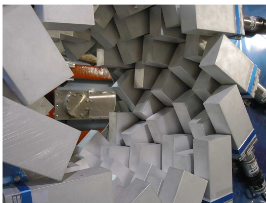
3.7. ábra. \text{NaI}(\text{Tl}) kristályok elrendezése a DALI2 \gamma -spektrométerben.
