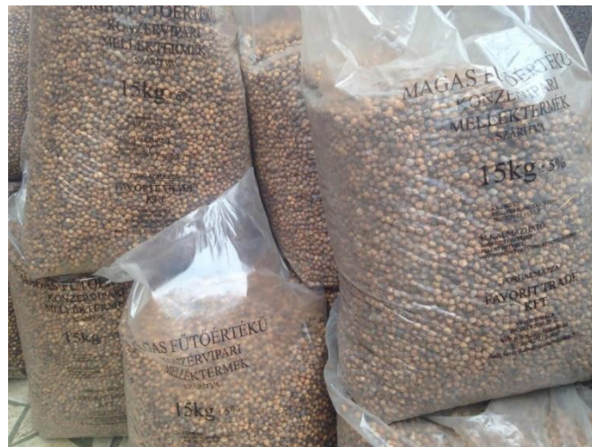
11. ábra. Csonthéjas magvából szárítással előállított magas fűtőértékű tüzelőanyag [I2]
