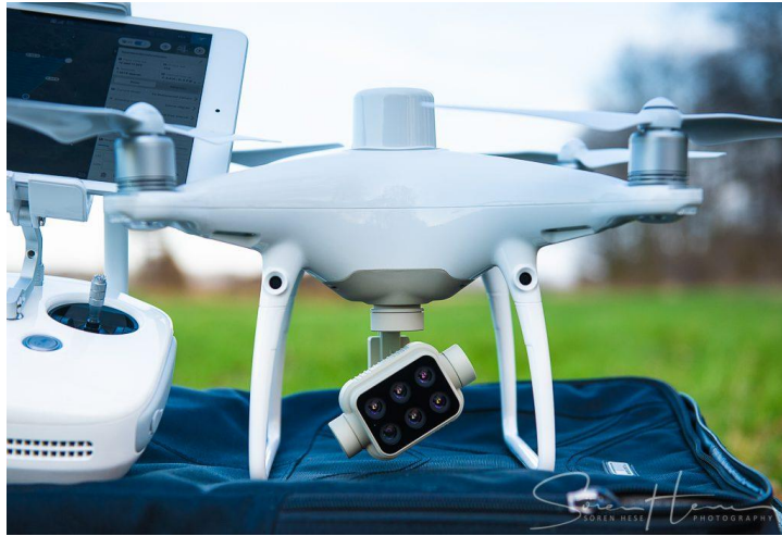
2. ábra: Phantom 4 Multispectral 6 kamerás rendszere
