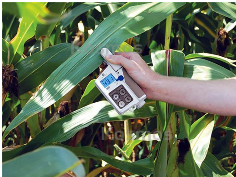
5. ábra: SPAD-502 relatív klorofilltartalom mérő műszer
