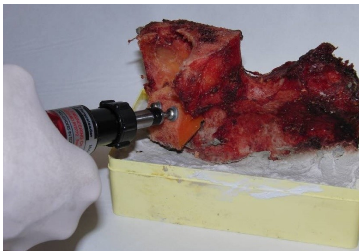
87. ábra. A csavarok meghúzása nyomaték csavarhúzóval
