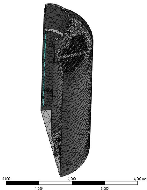
25. ábra behálózott kazán
