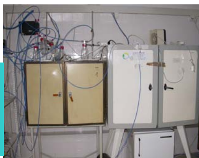
13. ábra. Anaerob fermentálás kísérleti bioreaktorokban ( Saját forrás )
