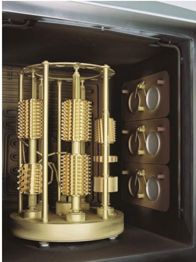
6. ábra PVD bevonatóló gép, bevonatolás után [9]
