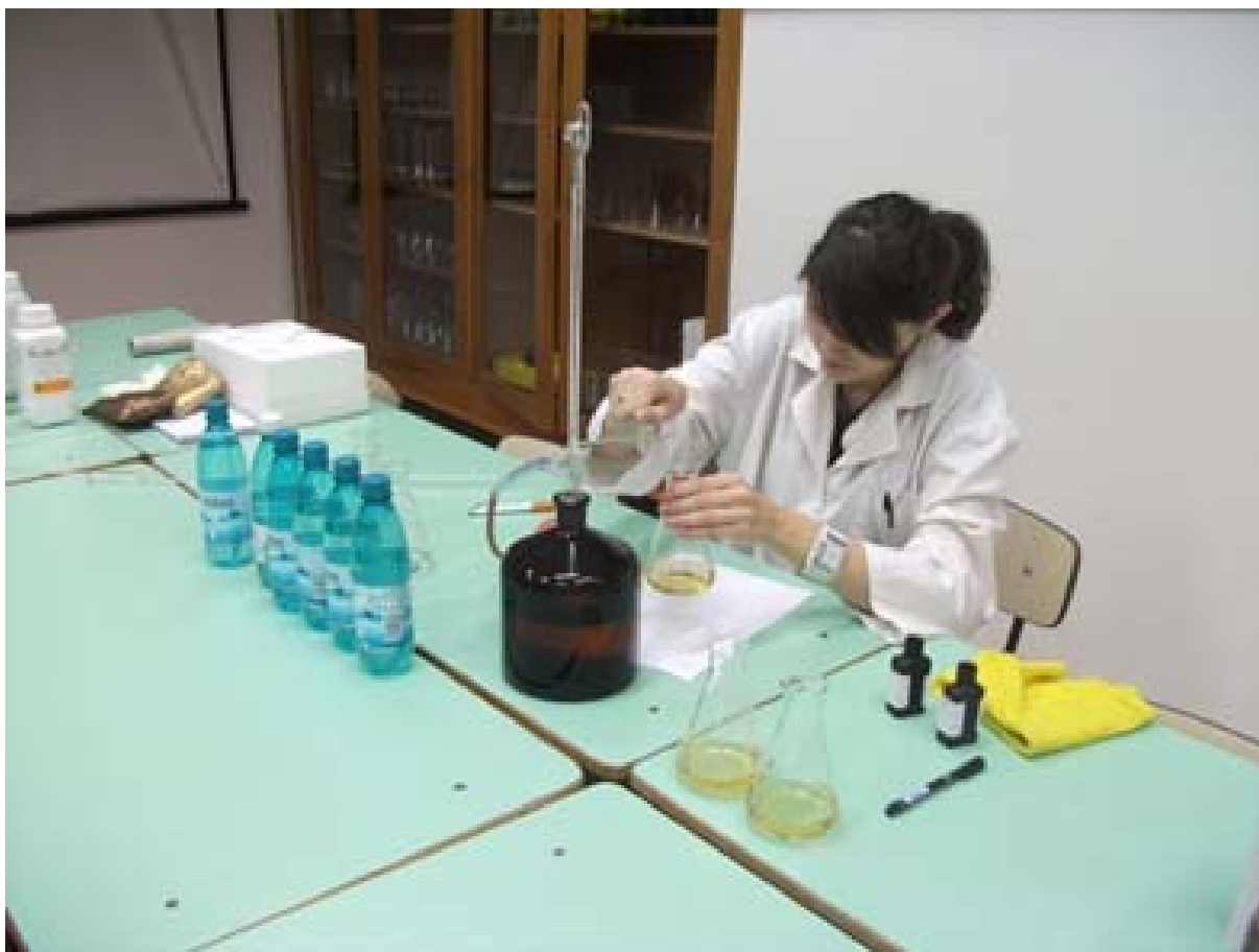
4. kép lúgosság mérése a Környezet- és Vegyészmérnöki Tanszék laboratóriumában (Készítette: Fórián Sándor)
