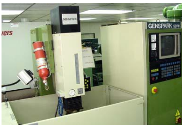
4.15. ábra: CNC szikraforgácsoló berendezés, késztermékek
