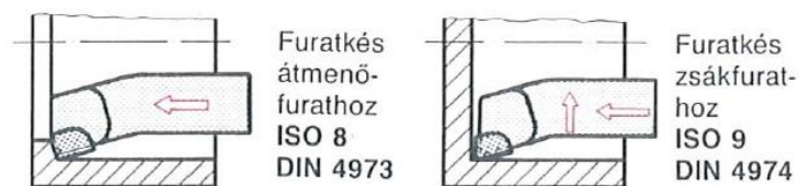
3.20. ábra: Forrasztott keményfémlapkás esztergakések belső felület megmunkálására
