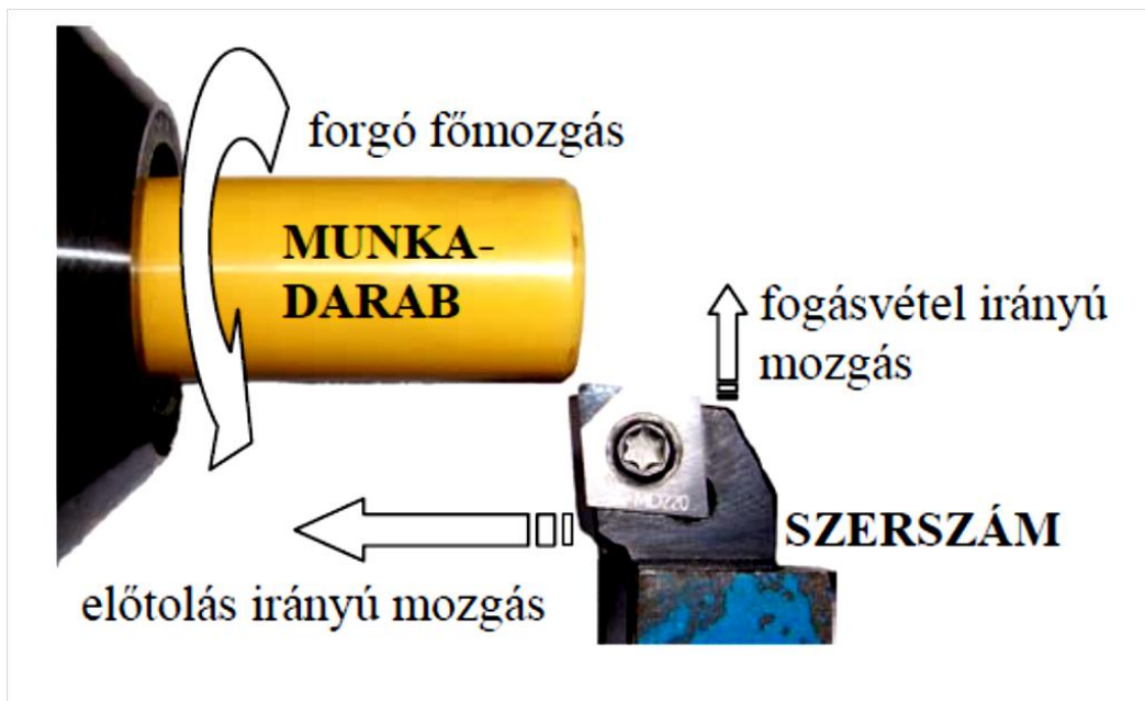
3.2. ábra: Mozgásvizonyok esztergálás esetén
