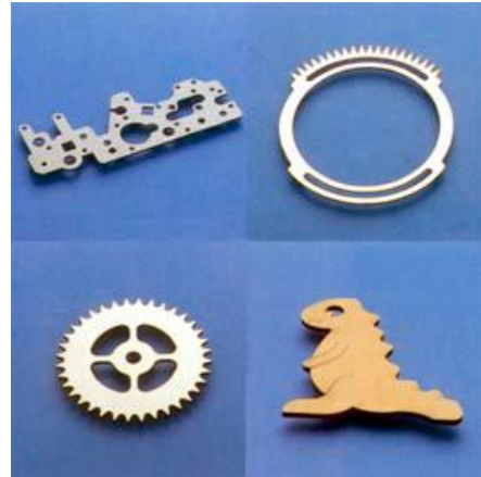
4.17. ábra: Lézeres CNC vágógép, késztermékek
