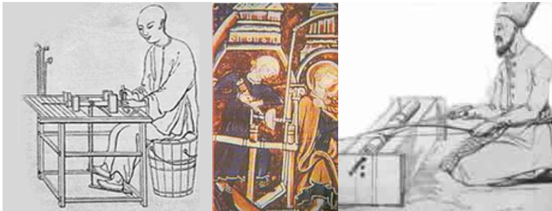
2.1. ábra: Kódex illusztrációk az első íj- és lábbal hajtott esztergákról
