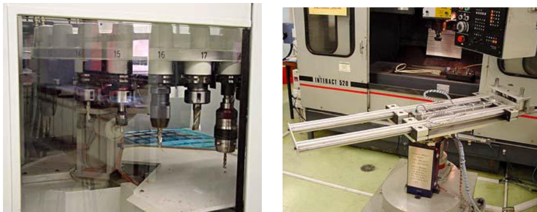
4.11. ábra: Szerszámtár, automatizált szerszámtár töltés
