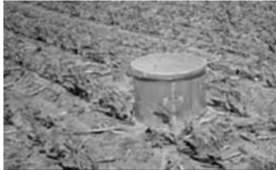
3. ábra: Egyszerű mérőhenger a mérési terület lehatárolására
