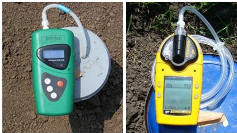
9. ábra: Az Anagas CD 98 típusú infravörös gázanalizátor (balra) és a GasAlertMicro5wPump típusú (jobbra) gázanalizátor ( Saját fotó )
