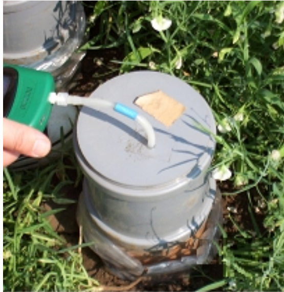
11. ábra: A hengeres módszer (Saját fotó)
