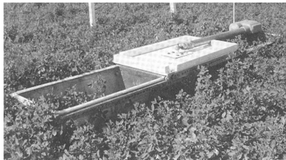
4. ábra: Automatikus szabadföldi kamrás gázanalizátor
