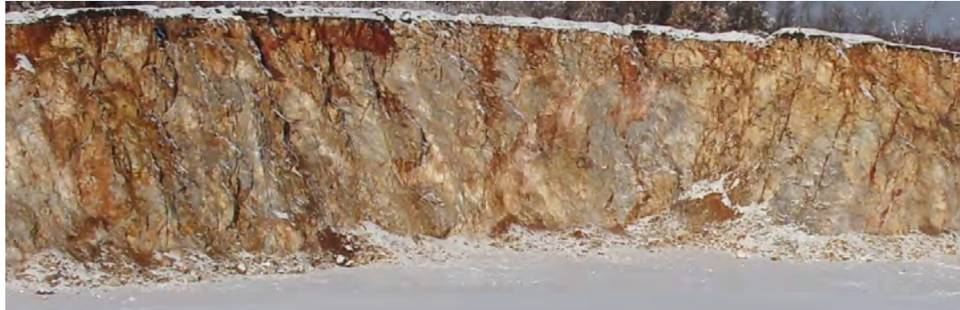
7.8.2. ábra: A Nagy-kőmázsa legfelső udvarának fejtési falán látható a többirányú igénybevétel következtében összetört kőzet néhány markáns feltolódási síkkal a kép jobb oldalán. Jobbra a bányában mért szerkezeti elemek sztereogramja látható
