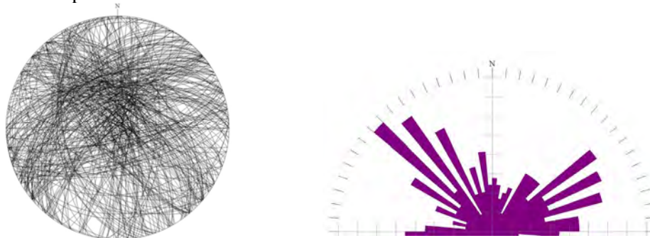
6.4.13. ábra: A Bükk-fennsík mikrotektonikai vizsgálati mintaterületének 24 mérési pontján mért litoklázis felületek dőlésének összesített sztereogramja és csapásirányainak eredő csillagdiagramja 358 mérés alapján
