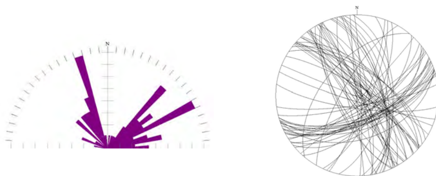
6.3.7. ábra: Az Imóközi karsztforrás melletti sziklafelszínen mért törések mérési eredményeit bemutató rózsadiagram és sztereogram
