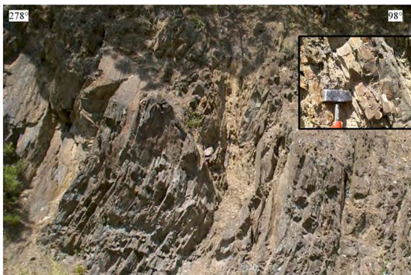
6.6.5. ábra: A Falu verője/c feltárás (6. mérési pont) 18–22m közötti szakasza a területre jellemző P_{II} által létrehozott meredek palásodási felszínekkel, amelyek összepréselt, enyhén görbült szubvertikális tengelysíkú redőben alakultak ki
