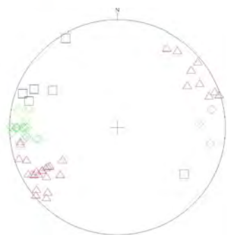
8.3.9. ábra: A Pécs-Abaliget közötti műút PAB-5 szelvénye, a redőtengelyek dőlés- és csapásirányának vektoros és projekciós ábrázolásával
