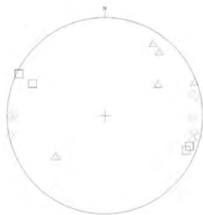
8.3.6. ábra: Misina (Mis2) szelvény redőtengely dőlés- és csapásirányának vektoros és projekciós ábrázolása
