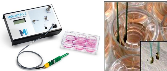
10. ábra. Millicell ERS-2 TEER meghatározó készülék és az elektródok elhelyezkedése a mérés során
