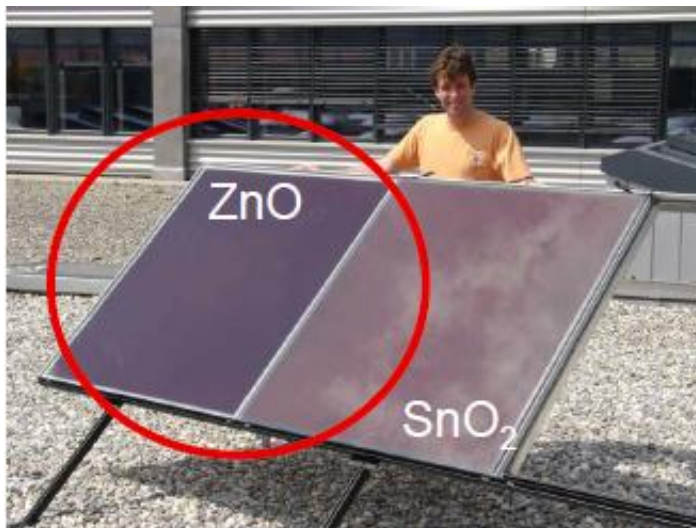
16. ábra - ZnO és az SnO 2 napelem modul összehasonlítása, a Cinkoxid modul teljesítménye 157W az Onoxidos modul teljesítménye 127W [19].
