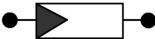
12. ábra – A napelem villamostechnikai rajza [4].
