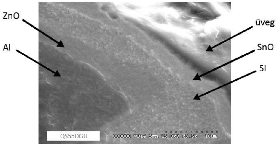
32. ábra - Elektronmikroszkóp felvétel a napelem cella rétegszerkezetéről
