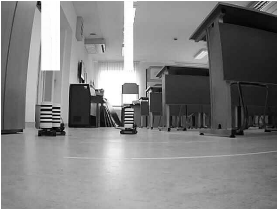
1.6. ábra. Társfelismerési algoritmus futása SRV-1 roboton. A felismert robotok a kép felső egyharmadán fehér színnel vannak jelölve.
