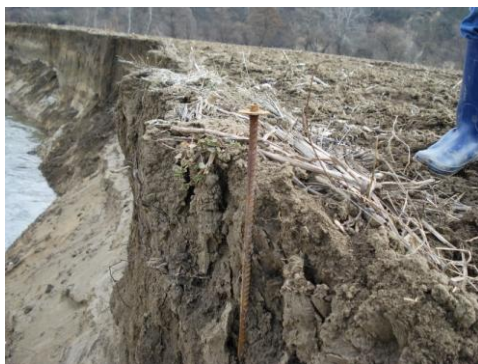
6. kép: Mérőkaró helyzete a pusztuló partfalon Sóstófalvánál
