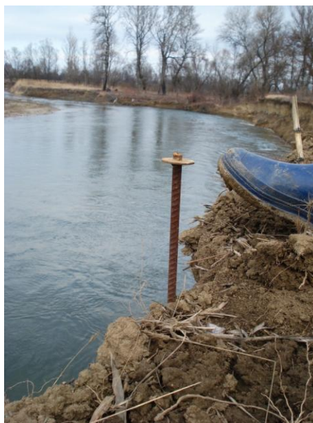
6. kép: Mérőkaró helyzete a pusztuló partfalon Sóstófalvánál
