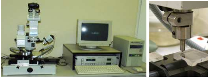
8. ábra. A Miskolci Egyetem Mechanikai Technológiai Tanszékén lévő, a karcvizsgálathoz használt, egyedi fejlesztésű karcvizsgáló berendezés
