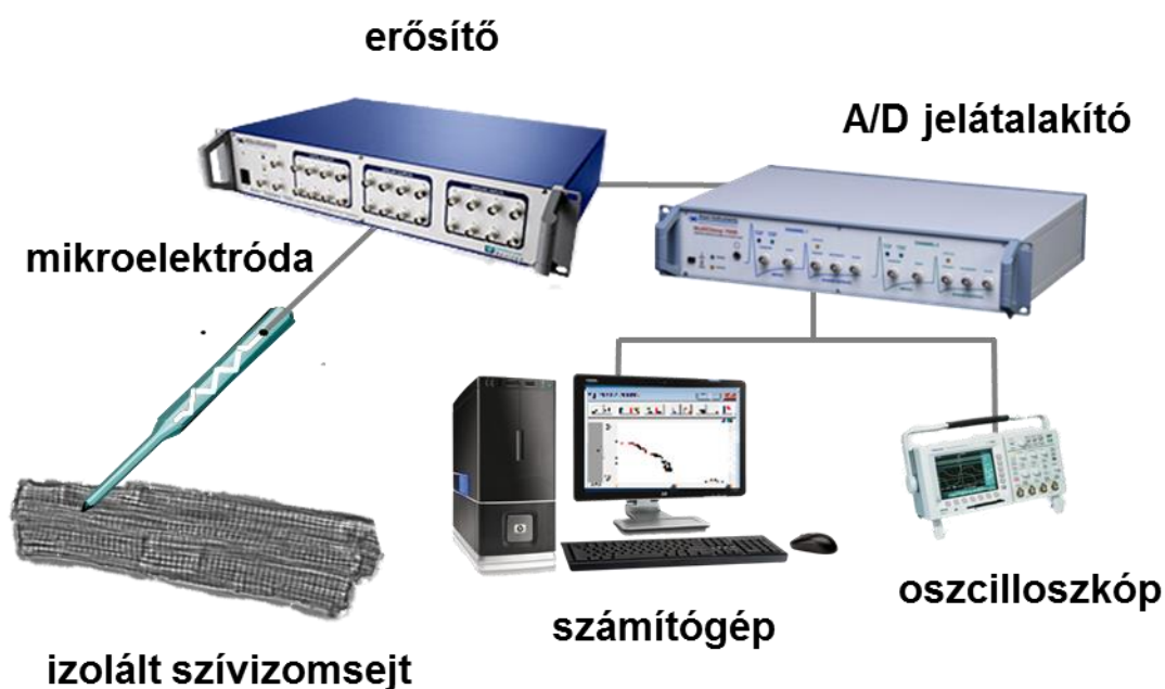
5. ábra Az elektrofiziológiai mérőrendszer felépítése
