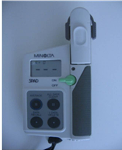
7. ábra SPAD-502 (Minolta, Oszaka, Japán) relatív klorofillmérő (fotó: Nagy, 2012)
