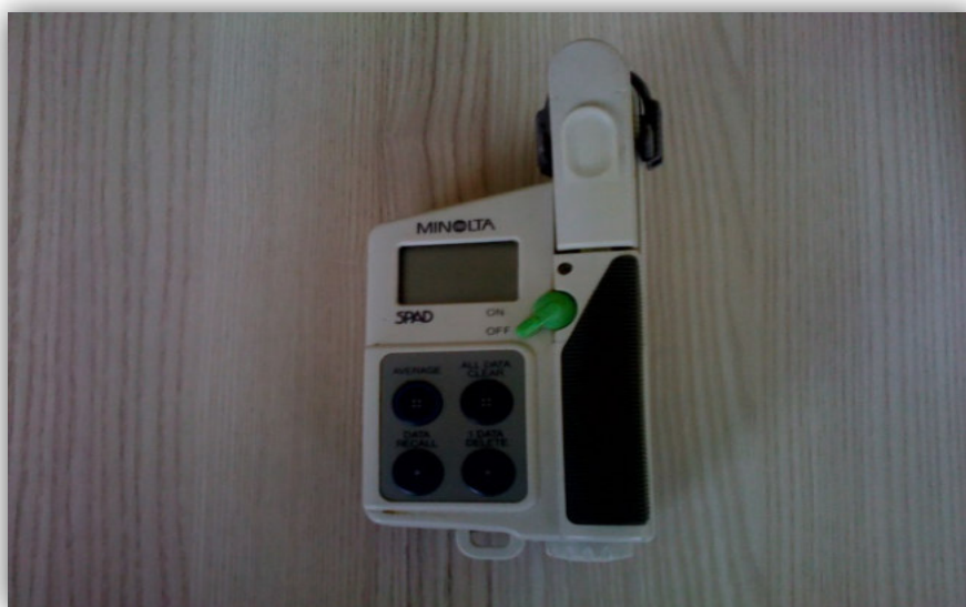
8. ábra: SPAD-502 klorofill tartalom mérő berendezés (Forrás: saját felvétel)
