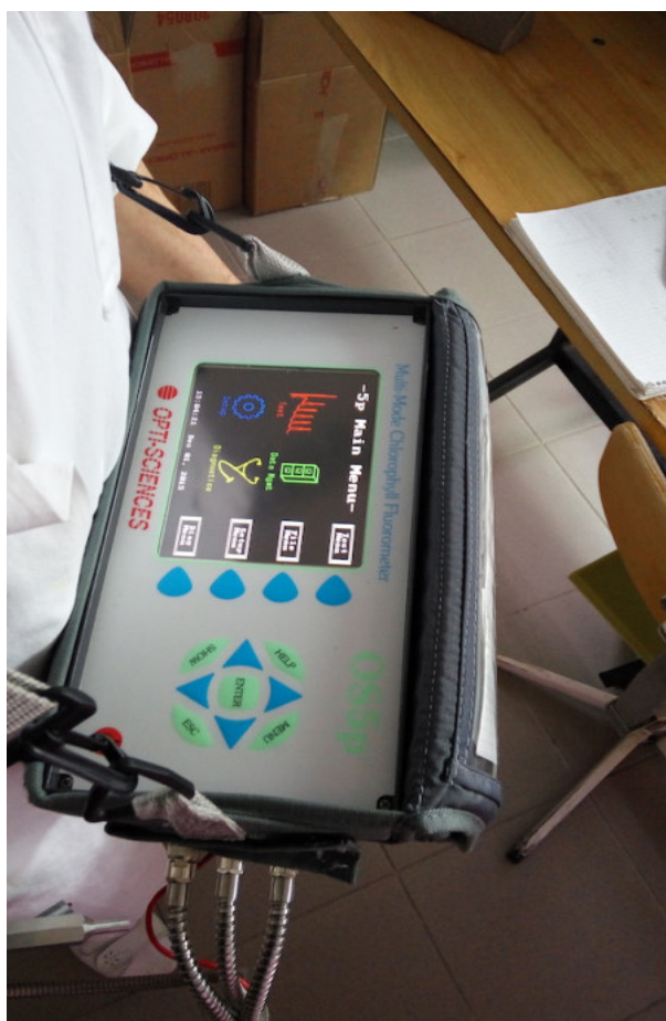
9. ábra: OS5p+ klorofill fluoreszcencia mérő berendezés (Forrás: saját felvétel)
