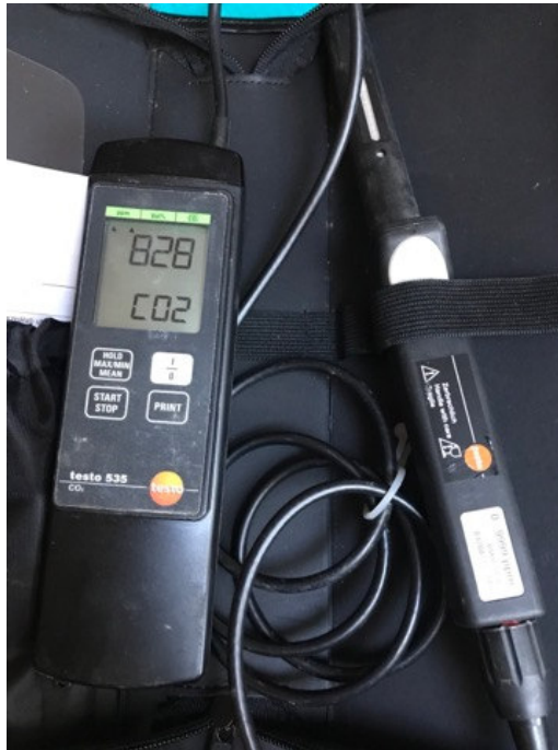
7. ábra: TESTO 535 CO 2 mérő berendezés (Forrás: saját felvétel)
