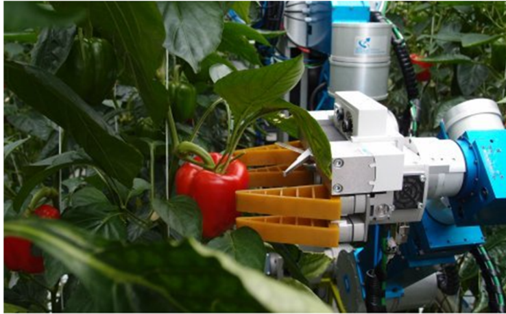
3. ábra: SWEEPER étkezési paprika szedő robot (Forrás: I3)
