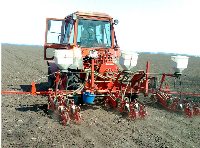
8. ábra Szemenkénti vetés precíziós vetőgéppel – a vetőmaggal együtt a tápanyag és a talajfertőtlenítő kijuttatása (Fotó: Vass, 2012)
