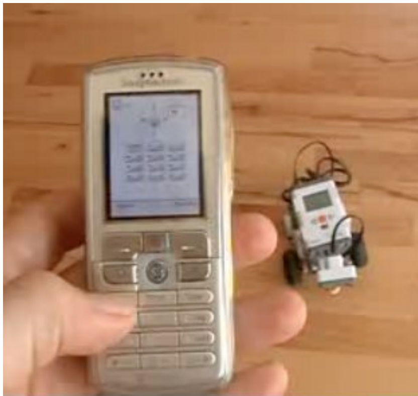
4. ábra. NXT vezérlése mobiltelefonról
