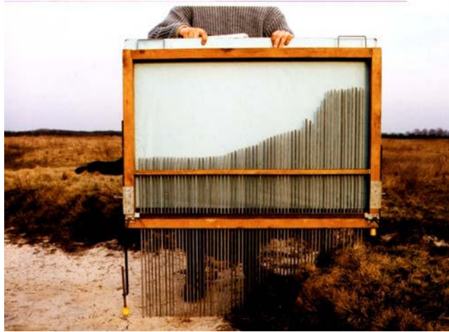
4. ábra A szikpadkák erózióját mérő profilométer (Nagy-Dögös)
