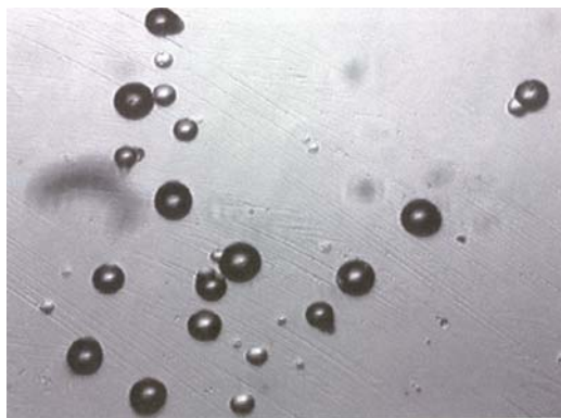
3. 10. ábra A nyomok felülnézeti képe 6 órás maratás után (A nagyítás 200-szoros.)
