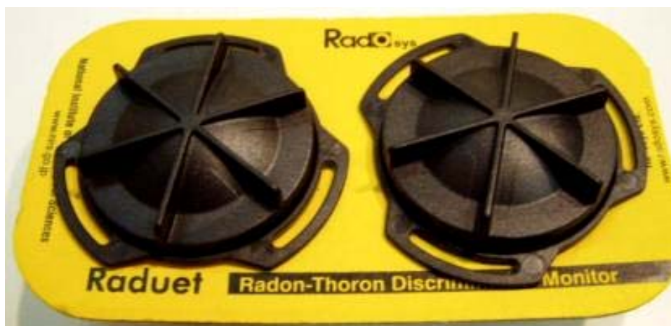
3. 21. ábra A Radosys Kft. által gyártott Raduet diszkriminatív radon-toron detektor (Forrás: www.radosys.com )
