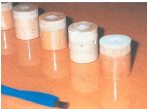
3. 3. ábra A detektorok összeszerelésénél használt fatöncök. A képen jól látható, hogy a detektorlemezek pontosan a tönk közepébe kerülnek.
