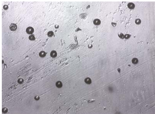
3. 9. ábra A nyomok felülnézeti képe 4 órás maratás után (A nagyítás 200-szoros.)
