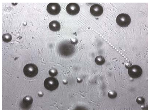
3. 11. ábra A nyomok felülnézeti képe 8 órás maratás után (A nagyítás 200-szoros.)
