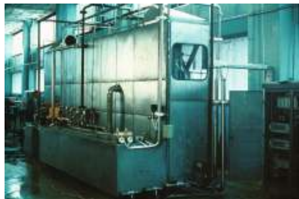
5. ábra. Vegyszeradagoló membrán szivattyúk az oldattartályon
