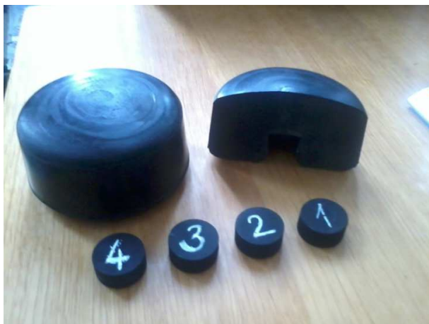
1. ábra Gumibak és a kiesztergált darabok
