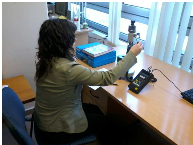
2. ábra A próbatetek keménységmérése
