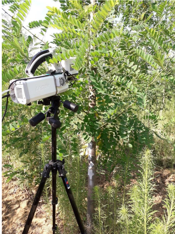
3. kép LI-6800 hordozható fotoszintézis mérőműszer (Saját fotó, Napkor, 2022.06.29.)
