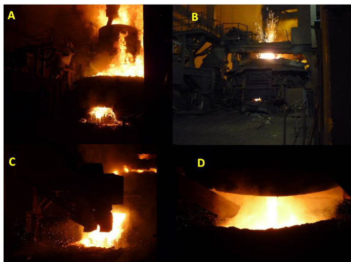
5/4. ábra Az OAM Kft ívkemence munkafolyamatának fázisai A/. kép: a vas- és acélhulladék beadagolása „kosárral”. B/. kép: a hulladék beolvasztása elektromos ívvel. C/. kép: oxigén befúvatás manipulátorral olvasztás közben. D/. kép: az acéolvadék csapolása EBT-rendszerrel.
