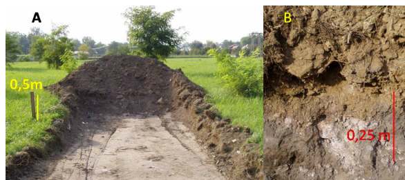
3/14. ábra A TESCO áruház helyén végzett előfeltárások kimutatták, hogy az allúvium felszínét vastag kohászati hulladék (samott) és szénalag réteggel töltötték fel, melyre 20-30cm-es talajborítás került. A belterületen a Hangony egyenetlen mocsaras ártere ezáltal eltűnt, a vízfolyás medrét szabályozták és burkolták.
