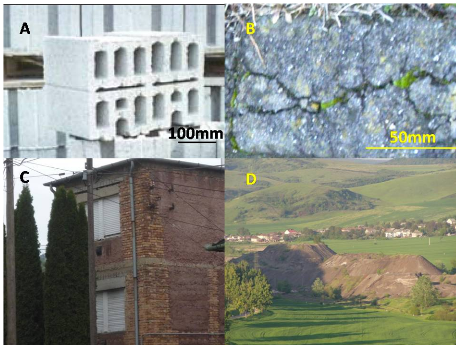
4/14. ábra Ózdi kohászati salakok hasznosítása. A/.kép: kohósalakból készült beton falazóblokkok ( www.aicherbeton.hu ). B/. kép: duzzadó Martin-salakból épített járdaszegély károsodása. C/. kép: a kazánsalak-betonból épített ház megfelelő stabilitású. D/.kép: vastalanított Martin-salak depóniája a centeri salakfeldolgozó területén (Borbás-hegy felől).
