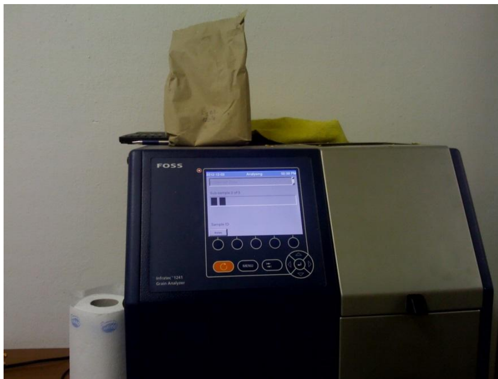
6. ábra: A kukoricaminták keményítőtartalmának méréséhez használt FOSS Infratec 1241 készülék
