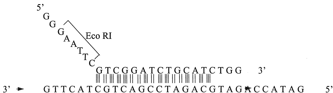
7. ábra. EcoRI restrikciós hely létrehozása PCR segítségével. Az ábrán az egyik oligonukleotid primer target DNS-el komplementer része és a restrikciós helyet tartalmazó túlnyúló 5'-vége látható
